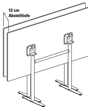
**Doppelsäulentisch mit freistehenden Fußauslegern für optimale Beinfreiheit. Tischsäulen verbunden durch Quertraverse aus Rundrohr, daher hohe Stabilität auch bei einer Tischhöhe von 105 cm. Fußausleger ausgerüstet mit nivellierbaren Fußgleitern (System FORMvorRAT). Ideal als Besprechungstisch, aber auch als Tisch für 4–6 Personen für Gastronomie oder Objekt.**
